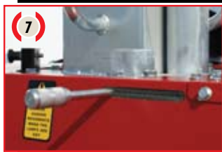
7 Blocco di rotazione con freno del tipo "a frizione"
